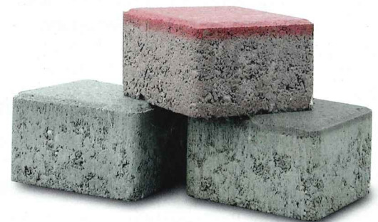
Die Pflastersteine sind in 3 Farben lieferbar: steingrau, rubinrot und anthrazit Gewicht: 610 g/Stück, Material: Beton DIN EN 1339, mit Fase, 2-schichtig, Witterungswiderstand D, Abriebwiderstand I
