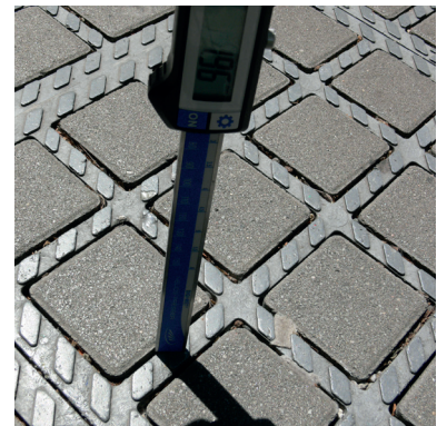
Vorgehen bei der Messung der Noppung.
